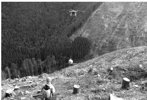
写真-6 資材を運搬する大型ドローン
