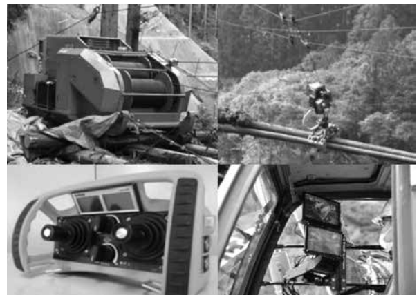
写真-5 遠隔操作式架線集材システム
