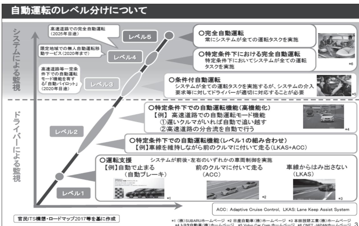
レベル4自動運転については運用範囲や運用速度を限定し、積極的にインフラ設備（路面に敷設した電磁誘導線や磁気マーカー・管制遠隔操縦装置等）と連携することで、実用化に向けた技術的なハードルは下がり、高齢化が進む地域における買物弱者・移動困難者問題等の解決手段としてのレベル4自動運転の早期実現の期待が高まっている。限定地域における無人運転車の公道走行のための制度づくりや実証実験が進められている。このような限定地域における近距離移動（通院・通学・買い物・公共
